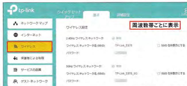
図20 「ワイヤレス」では、SSID名や暗号化キーの確認や変更ができる。「SSIDを非表示にする」をチェックすると、SSIDがWi-Fi子機から見えなくなって安全性が上がる(36ページ図3参照)。ただし、子機の接続の再設定が必要になるなど不都合もある
