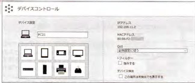
図8 図3で「デバイスコントロール」を押すと、Wi-Fiルーターに接続されている機器の情報が表示される。通信帯域の優先度を決める「QoS」や「i-フィルター」の適用などの設定が可能
