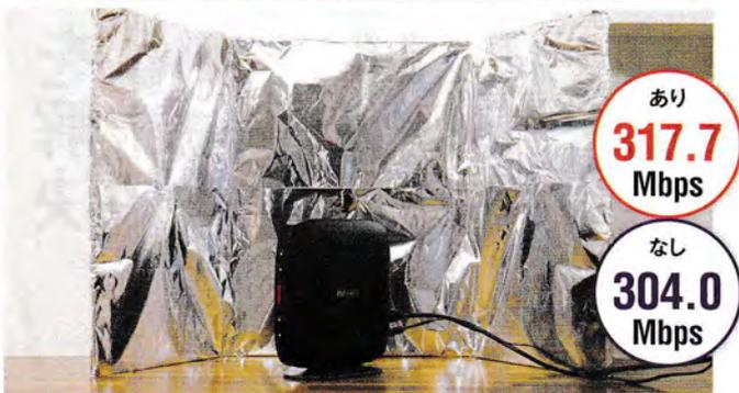
Ⓖ 図14 アルミホイルを巻いた段ボールで、親機の電波を強化できるのか。眉唾のような噂だが、反射板を使わなかった状態(25ページ図4)と比較しても、リビングでの通信速度が向上。一定の効果が認められた
