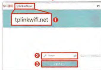
図18 ブラウザーで「tplinkwifi.net」と入力して、「Enter」キーを押す(1)。この機種(「Archer AC2600」)では、初回アクセス時に自分で設定したパスワードを入力してログインする(2,3)
