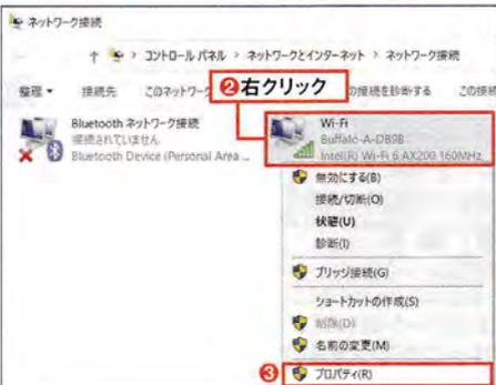
◎ 図6 IPv6のDNSサーバーは、パソコンで指定する。「設定」の「ネットワークとインターネット」から「アダプターのオプションを変更する」を開き(①)、変更したいアダプターの「プロパティ」を開く(②③)
