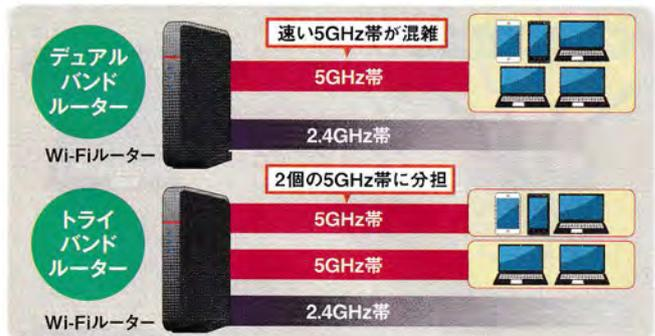
図8 Wi-Fiルーターの多くは、5GHz帯と2.4GHz帯を1個ずつ持つデュアルバンドルーターだ。なかには、5GHz帯を2個持つトライバンドルーターもある。接続する機器を2つの5GHz帯に分担できるので、台数が多い環境では有利
