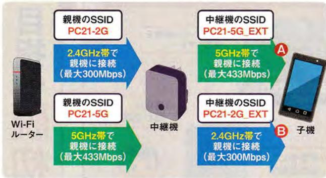
図8 中継機の接続は、親機と2.4GHz帯、子機とは5GHz帯で接続するパターンAと、その逆のパターンBがある[注]。どちらを利用するかは速度を計測して決めよう
