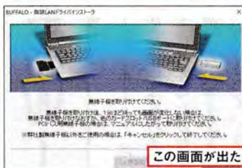
◎ 図6 バッファローの「WI-U3-866DS」を例に、パソコンへの取り付け方を紹介しよう。USB端子に挿す前に付属のCDからセットアップソフトを起動し、画面に指示が出てからUSB端子に挿す
