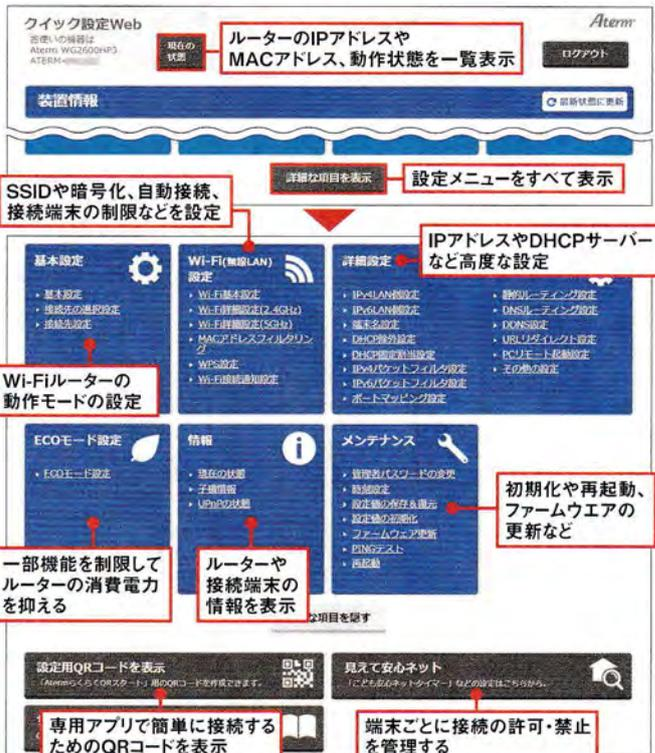
◎ 図13 最初に表示されるのは「基本設定」「Wi-Fi(無線LAN)設定」「情報」「メンテナンス」の4項目と、「設定用QRコードを表示」や「見えて安心ネット」などの便利機能。「詳細な項目を表示」を押すと、「詳細設定」「ECOモード設定」の2項目が増え、既存の項目にも新たなメニューが追加される
