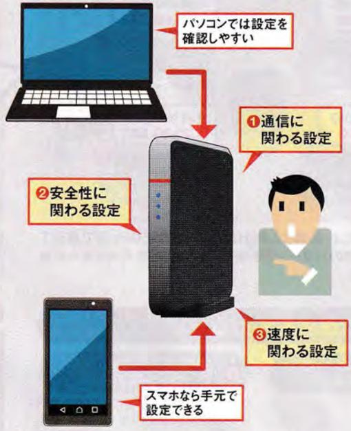
図1 Wi-Fiルーターの設定画面では、動作の確認のほか通信速度や安全性の向上などが図れる。通常、設定画面はパソコンのブラウザから開くが、メーカーが無料で提供しているスマホ用のアプリも便利。接続の制限や来客用のSSIDの有効化といった一時的な設定を、手軽に実行できるのがメリットだ
