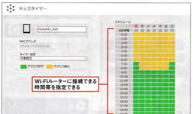
図7 図3で「キッズタイマー」を押すと、指定した端末のWi-Fiルーターへの接続を時間帯で制限できる。スケジュールは、「夜間禁止(23時~7時)」のほか、「手動設定」で曜日ごとに自由に指定することも可能
