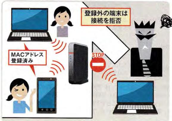
④ 図4 接続を許可する子機の固有番号「MACアドレス」をWi-Fiルーターに事前に登録し、それ以外の子機からの接続を制限できる。一般に「MACアドレスフィルタリング」と呼ばれる
