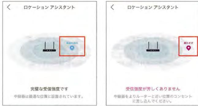
図6 図5で示した3カ所に中継機を設置し、親機の電波受信強度を本体のLEDとスマホアプリで調べた。結果は廊下の受信強度がベスト、リビングも良好。だが子ども部屋内は受信強度に問題ありとなった
