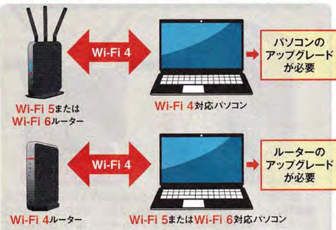
◎ 図4 Wi-Fi 5やWi-Fi 6のルーターを買ってきても、パソコンやスマホがWi-Fi 4までしか対応していないと、通信速度はWi-Fi 4となる。逆も同じだ。遅いほうに引っ張られるため、買い替えるときは双方をWi-Fi 5かWi-Fi 6に対応させる必要がある。パソコンやスマホ、ルーターが対応しているWi-Fi規格を調べる方法は13~14ページを参照
