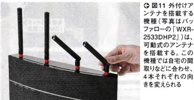
Ⓖ 図11 外付けアンテナを搭載する機種(写真はバッファローの「WXR-2533DHP2」)は、可動式のアンテナを搭載する。この機種では自宅の間取りなどに合わせ、4本それぞれの向きを変えられる
