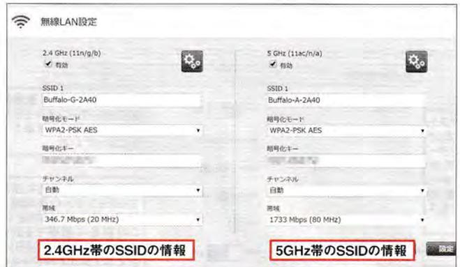
図4 図3で「無線LAN」を選択すると、5GHz帯と2.4GHz帯のSSIDごとに名称や暗号化の設定、使用チャンネルなどの確認・変更ができる。これは簡易な設定で、図9では詳細な設定が可能だ
