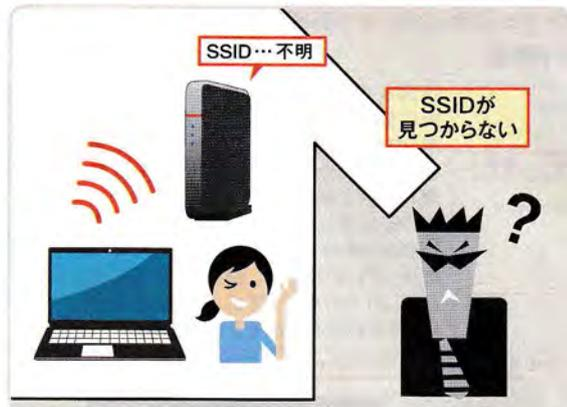
④ 図1 Wi-Fiルーターの「ステルス」機能を使えば、SSIDが周囲から見えなくなり、第三者から簡単にはアクセスされなくなる
