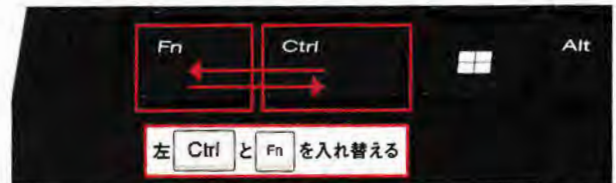
図1 一部のノートパソコンは左端に「Fn」キーを備える。この配置が使いにくければ、隣の「Ctrl」キーと機能を入れ替えてしまおう
