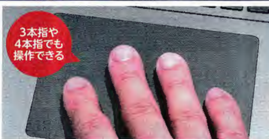
図1 タッチパネルやタッチパッドの多くは、3~4本指での操作に対応している。これを使えば、操作がより楽になる。なおハードウェアの対応が必須。一部のパソコンでは利用できない
