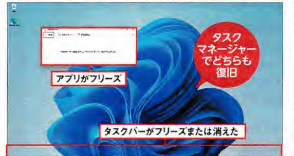
図1 アプリがフリーズしてデスクトップ画面に残るときは、「タスクマネージャー」でアプリを強制終了すればよい。ただし、作業中のデータは消える。タスクバーがフリーズまたは消えても、タスクマネージャーで復旧できる
