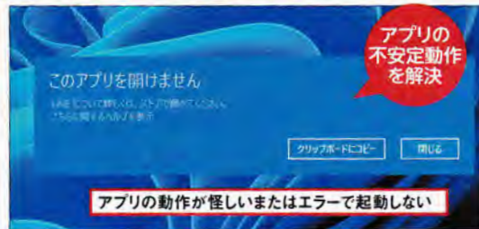
図1 アプリの動作がおかしい、まったく起動しないような場合、再インストールせず修復やリセットを試みよう。ストアアプリの場合、アプリの修復やリセットを実行可能だ
