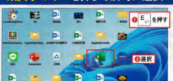
図1 デスクトップ画面をクリックし、探しているファイルやアプリの頭文字のキーを押すと、該当するものが瞬時に選択される。ここではIMEがオフの状態で「E」キーを押したら、Excelのアプリが選択された(1,2)
