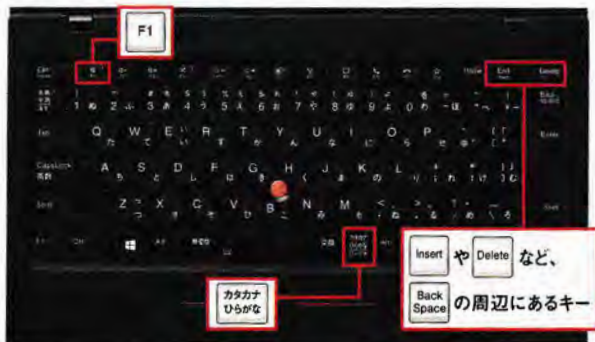
図5 「F1」キー以外にも、日本語の文字入力方法を切り替える「カタカナ／ひらがな」キー、間違えて押しやすい「Insert」キーや「Delete」キーなどを無効にしておく、誤操作を防げる
