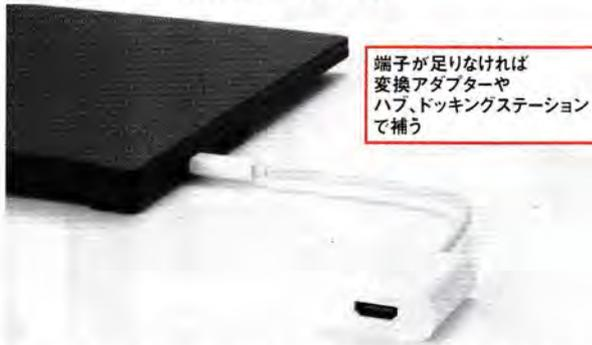
図3 DP Altに対応するUSB Type-C端子なら、変換アダプターを用意すれば映像出力端子として利用できる。また、USBハブや小型ドッキングステーションなどを用意すれば、足りない端子を補える
