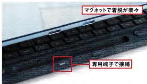
図6 一般的にデタッチャブル型のキーボードは、専用の端子で本体と接続する。この機種はマグネットで簡単に着脱できるようになっている【注】
