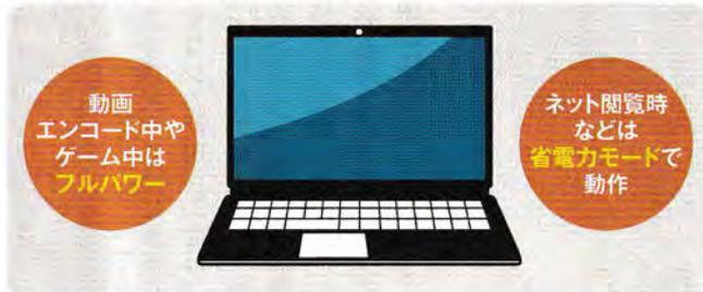
図5 最近ではユーザーの使用状況に応じて、AIがCPUパワーやファンの回転数、画面の明るさなどを自動で調整して消費電力を下げる機能を搭載しているパソコンが多い
