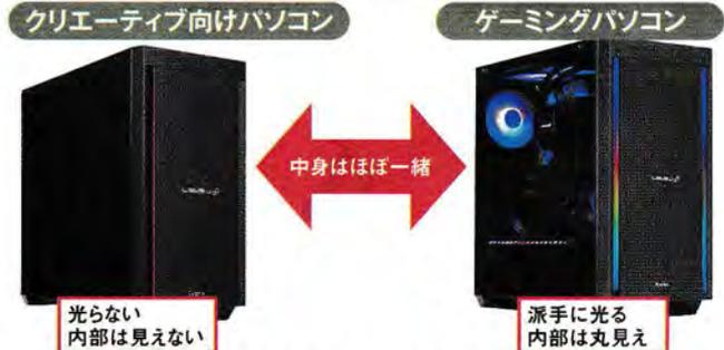
図4 ゲーミングパソコンの外観は、派手に光らせてたり内部を見えるようにしたりと個性的。しかし、クリエイティブ向けパソコンと使う部品はほぼ同じだ。もちろん、ゲーミングパソコンをゲーム以外の用途でも利用できる
