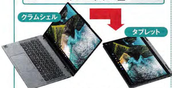
図1 通常時は一般にクラムシェル型と呼ばれるノートパソコン。ヒンジを軸に360度回転してタブレットに変形するタイプをコンバーチブル型と呼ぶ。キーボードを使った入力作業が多ければこちらが向く。写真はレノボの「Idea Pad 5x 2-in-1 Gen 9」
