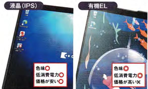
図3 IPS方式の液晶は、色合いが良く低消費電力で動作するうえに価格も安い。有機ELは、色合いと省エネ性能の両面でIPS方式より優れているが、価格が高い。予算に余裕があれば有機ELを選びたい
