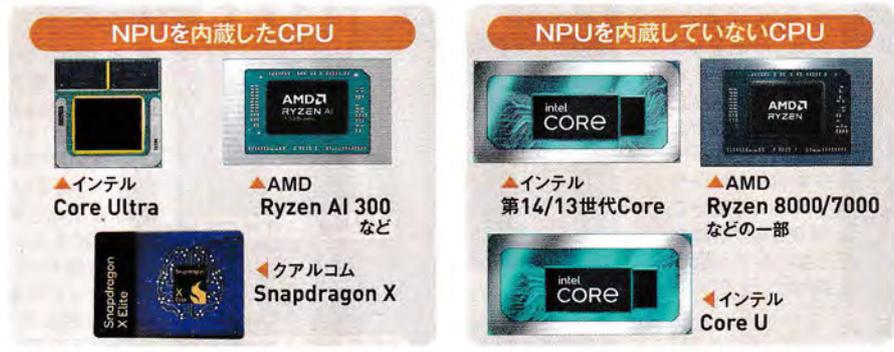
図1 現行のノートパソコン向けCPU（実際はCPUだけでなくチップセットやGPUなども内蔵した統合型プロセッサ）は、AI処理専用のNPU（Neural Processing Unit）を内蔵したものと内蔵していないものに大別できる
