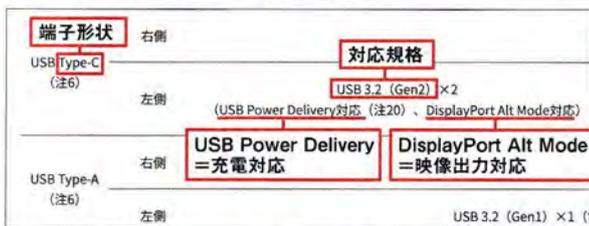
図1 モバイルノートの端子類をチェックする際は、USBの拡張規格に着目したい。充電対応の「USB PD」[注1]と映像出力対応の「DP Alt」[注2]は今や必須のインタフェースだ
