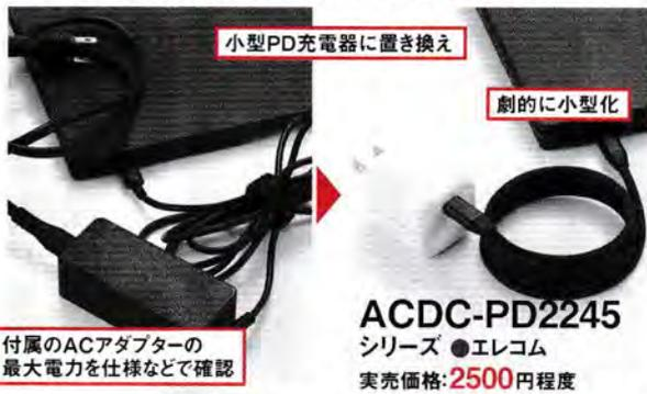
図4 USB PD 端子を備えたモバイルノートなら、付属のACアダプターを他社の小型充電器に置き換えることも可能。その際、付属のACアダプターの最大電力以上を出力できる小型充電器を選ぶ。それをスマホの充電にも使用できる
