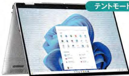
図2 キーボードを背面に回転して自立させた形態を「テントモード」と呼ぶ。動画視聴などに向くモードで設置スペースが小さくて済む。キーボードは使えないのでタッチで操作する。写真はHPの「Envy x360 16-ac」
