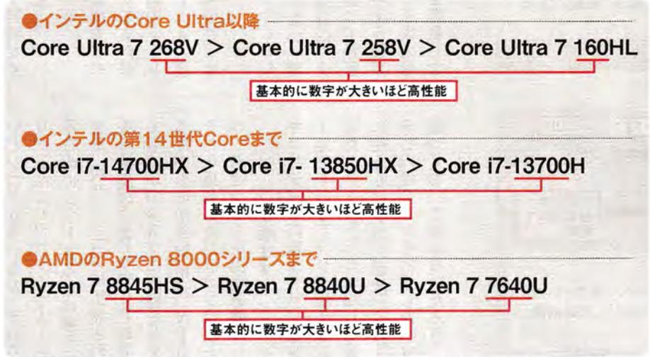
図2 同じグレードのCPUの性能の優劣はプロセッサナンバーで判断できる。数字が大きいほど世代が新しく高性能。末尾のアルファベットはカテゴリーを示しているが、その意味は世代で異なる。詳細はメーカーのウェブサイトなどで確認できる
