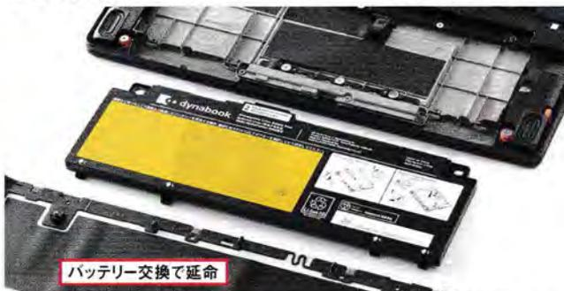
図9 バッテリーは充電回数で500~1000回、使用期間で3~5年程度で劣化するといわれている。できるだけ長く使いたいなら、自分でバッテリーを交換できる製品を選ぶとよい。その分、寿命は長くなる
