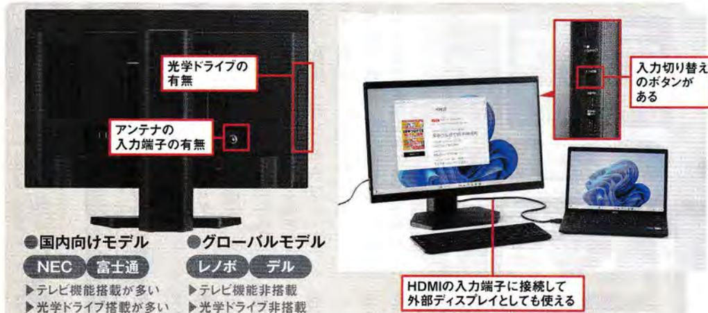
図4 一体型デスクトップを選ぶときの大きなポイントはテレビ機能の有無だ。国内での販売が中心のNECや富士通は、アンテナの入力端子を搭載するモデルがある(左)。グローバルで展開するレノボやデルのモデルはアンテナの入力端子を搭載しないほか、一部のカスタマイズを除き、DVDなどの光学ドライブを搭載しない。HDMIなどの映像入力端子を搭載していれば、外部ディスプレイとしても使える(右)
