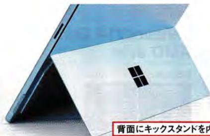
図5 デタッチャブル型は自立させるために、背面にキックスタンドを設けている機種もある。Surface Proでは無段階で角度調整が可能だ
