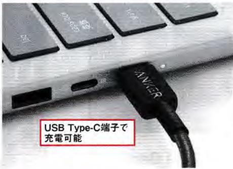
図11 6モデルともUSB PDに対応するので、市販のUSB PD対応充電器を使ってUSB Type-C経由で充電が可能。専用の電源アダプターを持ち歩かなくて済むのは楽だ
