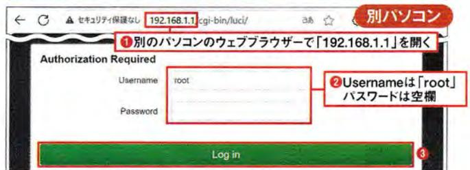
図6 OpenWrtを起動するパソコンと別の設定用パソコンをLANケーブルで直結し、作成したUSBメモリーで起動する。OpenWrtを起動したパソコンの画面にログが流れなくなると起動完了となり、設定用パソコンのウェブブラウザから設定画面を開ける(1~3)
