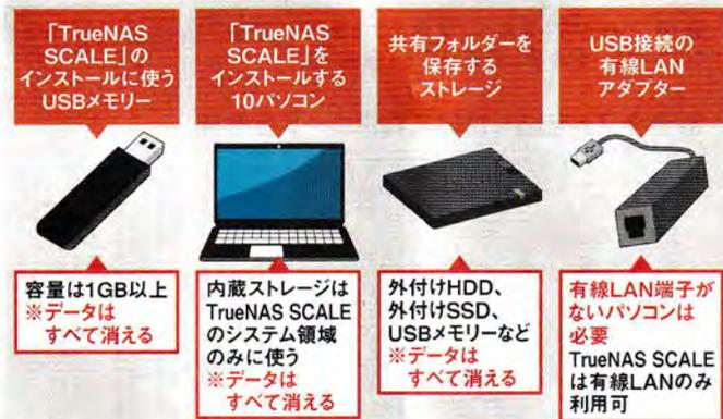
図2 TrueNAS SCALEはWi-Fiを利用できないため、有線LANで接続する。パソコンの内蔵ストレージはシステム専用で共有フォルダを作れないため、データ保存用の外付けストレージが別途必要だ。またインストール用のUSBメモリも用意する。これらのストレージのデータはすべて消える
