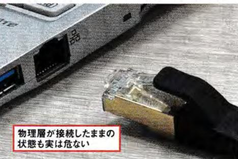
図11 図10の操作で切断しても、LANケーブルがそのままだとネットワークの物理層は接続したまま。不測の事態を招く恐れもあるので必ず抜いておく
